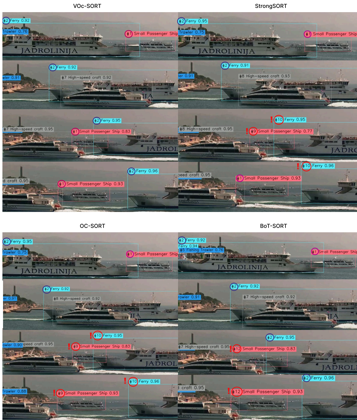
Slika 7.5: Primjer ponašanja odabranih algoritama praćenja (VOC-SORT, StrongSORT, OC-SORT i BoT-SORT) na dijelu SSMOT_9 videozapisa s međusobnim preklapanjem plovila i primjerom duge okluzije putničkog broda trajektom.
